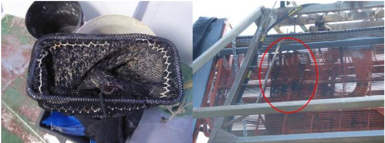
Figura 14. Retino campionario costituito da un frame di acciaio inox (40 cm di lunghezza interna, 20 cm di larghezza interna con uno spessore di 1 cm) e una rete di nylon con maglia da 12 mm di apertura.
